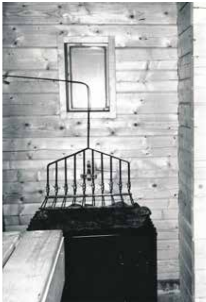
Yleisnäkymä koesaunasta, joka on rakennettu valmiisiin sisätiloihin. Kiukaan yläpuolella on säädettävä ja automaattinen vedenannostelija ja sen yläpuolella tarkkailuikkuna. Seinällä on kuiva- ja märkälämpömittaripari.
