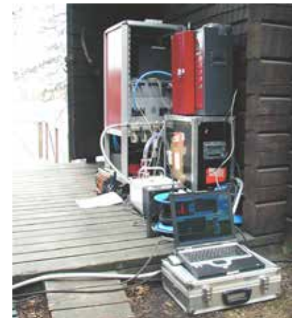
Kuva 2. ELPI-laitteisto (Dekati Oy) Tampereen Hangaslahden savusaunalla mittamassa pienhiukkasia lämmityksen aikana. Tietokoneen monitorissa näkyy nopeita hiukkasryöppyjä.
