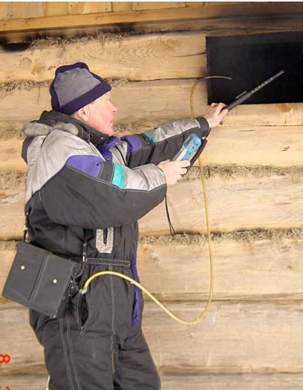
KUVA 1. Hiukkas-, häkä ja hiilidioksidimittaus räppänästä (Sibata- ja Dräger-laitteet).
